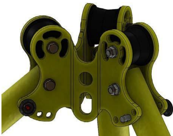
Figure 2 – Tête avec réglage des jambes en 3 étapes
